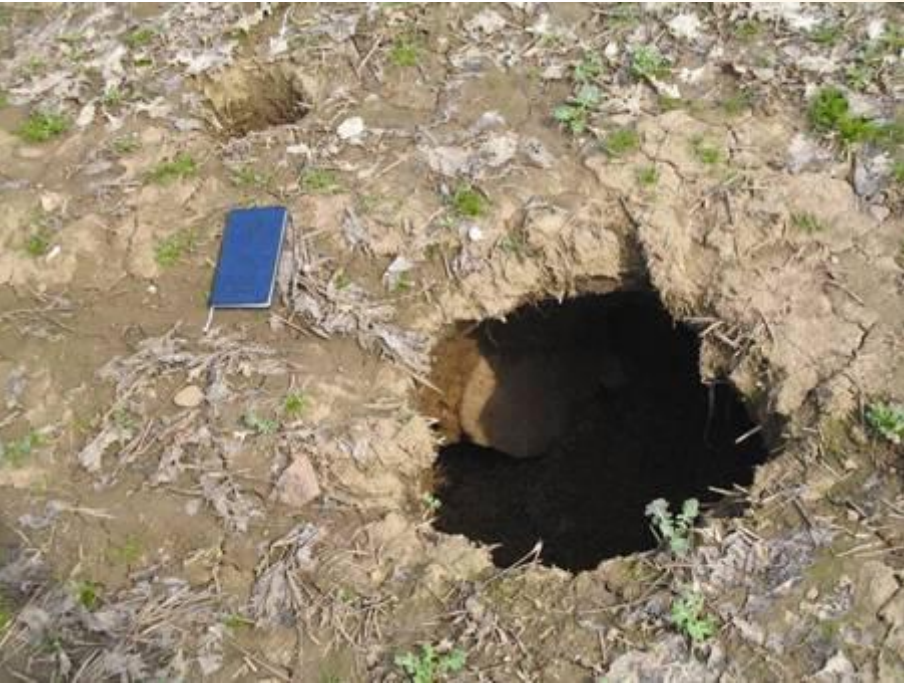
Kaverna, způsobená vnitřní erozí půdy v místě drénu a následným vyplavením půdních částic.
